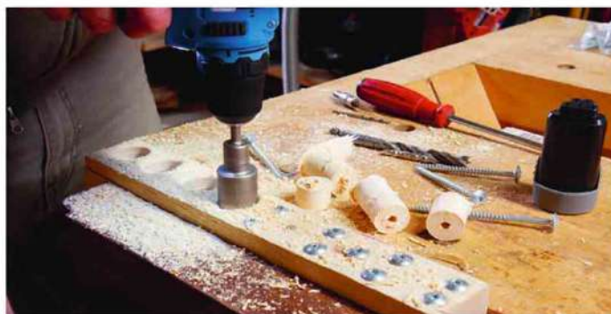
Il trapano Fervi nell'uso al limite delle specifiche (e oltre). In foto l'inserimento di viti 6x70 mm e la serie di forature \varnothing 30 mm su abete; la buona potenza della macchina permette di concludere il lavoro senza problemi.
