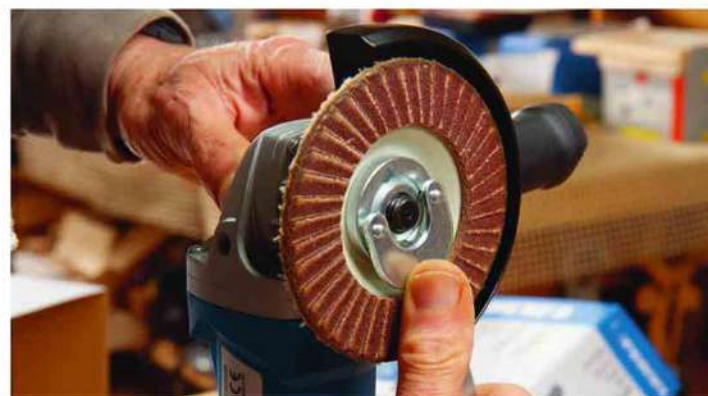
Pur non avendo un sistema di fissaggio rapido del disco, lo stazionamento in verticale della smerigliatrice libera una mano facilitando l'operazione.
