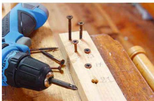
Il trapano Fervi nell'uso al limite delle specifiche (e oltre). In foto l'inserimento di viti 6x70 mm e la serie di forature \varnothing 30 mm su abete; la buona potenza della macchina permette di concludere il lavoro senza problemi.
