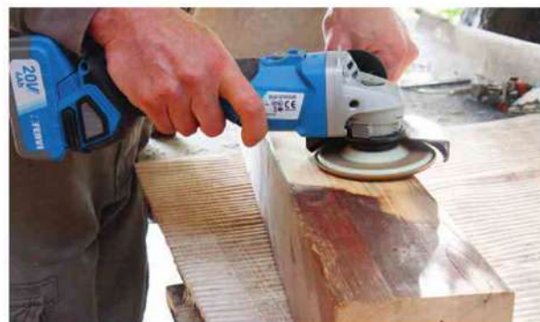
La sensibilità con cui si riesce a lavorare permette di usare la smerigliatrice non solo nei lavori di sgrossa ma anche in quelli più delicati di sverniciatura e levigatura del legno.
