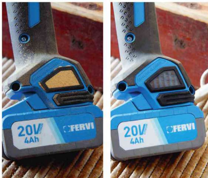
Le lavorazioni su legno possono intasare rapidamente i filtri delle due prese d'aria inferiori. Possono essere soffiati con il compressore o ripuliti velocemente dalla polvere con un pennello.
