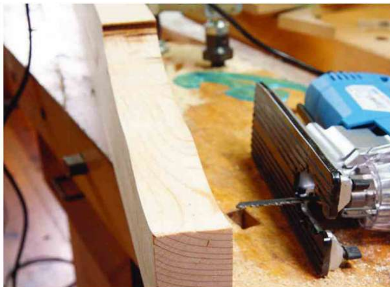
Anche tagliando alla massima capacità su traiettorie curvilinee la lama non sbandiera; la rigidità della guida a rullo permette di mantenere una buona ortogonalità anche nei tagli più profondi.
