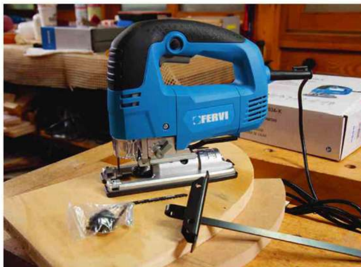
Nelle dotazioni del seghetto, il manuale, la guida parallela, il dispositivo per tagli circolari e una lama.
