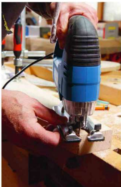
Anche tagliando alla massima capacità su traiettorie curvilinee la lama non sbandiera; la rigidità della guida a rullo permette di mantenere una buona ortogonalità anche nei tagli più profondi.
