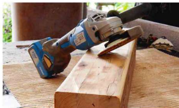
La sensibilità con cui si riesce a lavorare permette di usare la smerigliatrice non solo nei lavori di sgrossa ma anche in quelli più delicati di sverniciatura e levigatura del legno.
