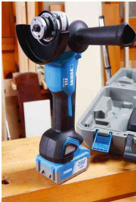
L'ampia base di appoggio della batteria permette lo stazionamento in verticale della smerigliatrice. Si nota in basso una delle due prese d'aria in ingresso ben protetta da un filtro in maglie metalliche. Qui sopra il pulsante di avviamento, il tasto di blocco dell'albero e il pulsante per la rotazione della cuffia di protezione.
