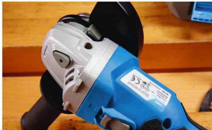
L'ampia base di appoggio della batteria permette lo stazionamento in verticale della smerigliatrice. Si nota in basso una delle due prese d'aria in ingresso ben protetta da un filtro in maglie metalliche. Qui sopra il pulsante di avviamento, il tasto di blocco dell'albero e il pulsante per la rotazione della cuffia di protezione.
