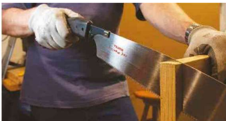
Ullmann - La sega professionale con lama giapponese Japan Rapid Pull 265 Tajima consente tagli rapidi, puliti, precisi anche in profondità. La lama è più sottile rispetto a quella di una sega tradizionale, più affilata, di un acciaio più duro che non flette. Può montare lame diverse a seconda dell'uso: la lama di serie da 265 mm con 16 dpi può essere sostituita velocemente con lame di lunghezze e dentature diverse; oppure con lame "nere" in acciaio temprato con rivestimento antiaderente che restano sempre fredde e non inchiodano, perfette per tagliare legni duri o resinosi.
