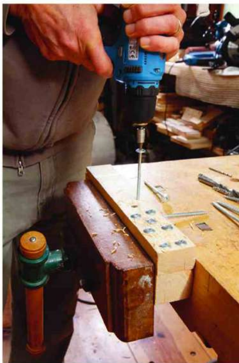
Il trapano Fervi nell'uso al limite delle specifiche (e oltre). In foto l'inserimento di viti 6x70 mm e la serie di forature \varnothing 30 mm su abete; la buona potenza della macchina permette di concludere il lavoro senza problemi.
