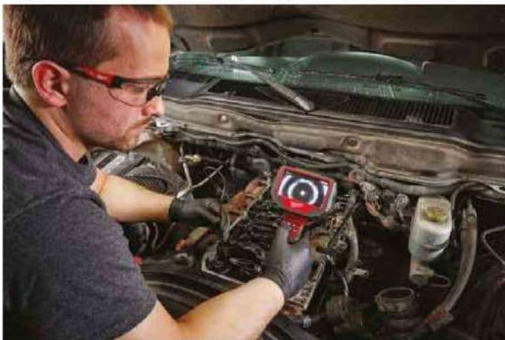
Milwaukee - Sarà disponibile dal gennaio prossimo il nuovo videoscopio per ispezione alimentato dalla piattaforma di batterie ricaricabili M12. La doppia telecamera frontale e laterale facilita l'identificazione di crepe e altri problemi su motore e altre aree del veicolo e la sua sezione, di soli 5mm, consente di accedere a punti stretti come i fori delle candele e i cilindri. Immagini e video vengono memorizzati nella scheda micro SD in dotazione con memoria di 32 GB.
